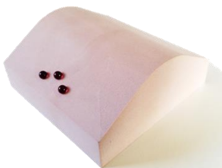
Abbildung 8-2: Referenzkörpergeometrie mit Referenzmerkmalen
