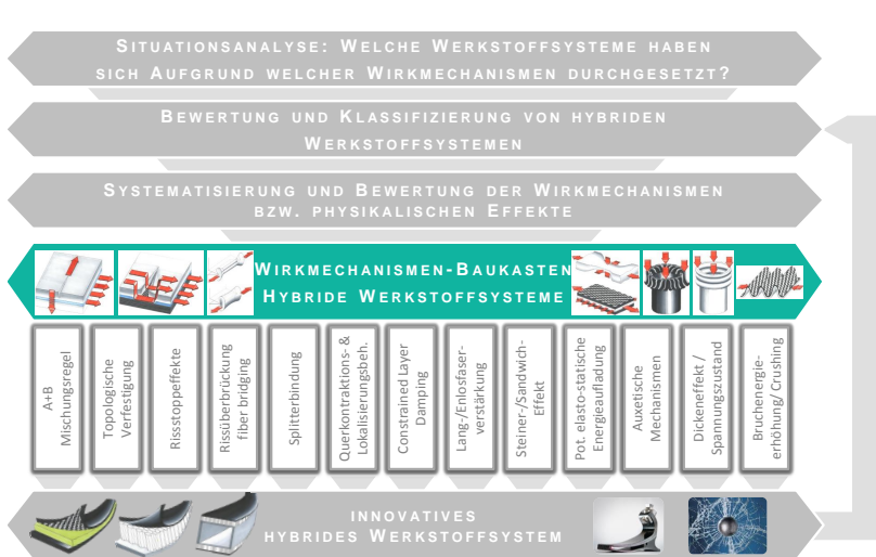
Abbildung 1.1: Allgemeine Vorgehensweise zur zielgerichteten Entwicklung mechanismenbasierter innovativer hybrider Werkstoffsysteme.
