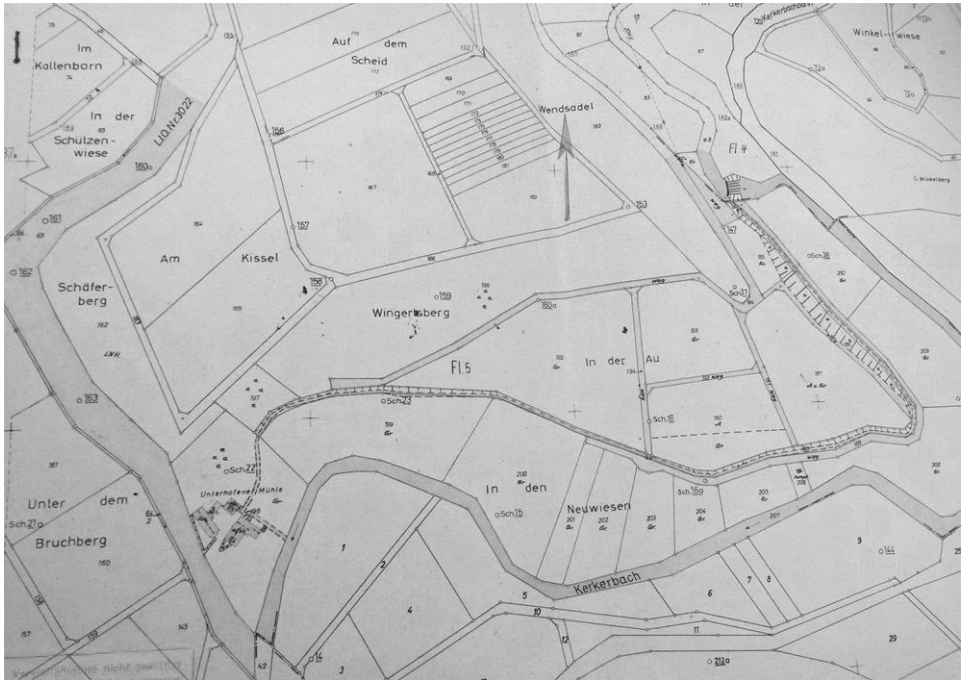
Abbildung 4: Dieser Ausschnitt der Flurkarte (1963) zeigt den Verlauf des Mühlgrabens vom Wehr (rechts oben) bis zur Wassermühle (links unten), der das Betriebswasser parallel zum natürlichen Flussbett über einen Kilometer in Richtung Kraftstation leitet [Foto: Privatarchiv Dorn].
