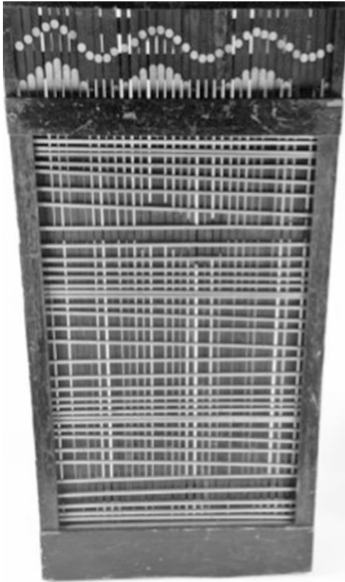
Abbildung 2: Carl Eitz' Apparat zur Veranschaulichung fortschreitender und stehender Transversal- und Longitudinalschwingungen [Foto: Universität Regensburg, Historische Instrumentensammlung].
