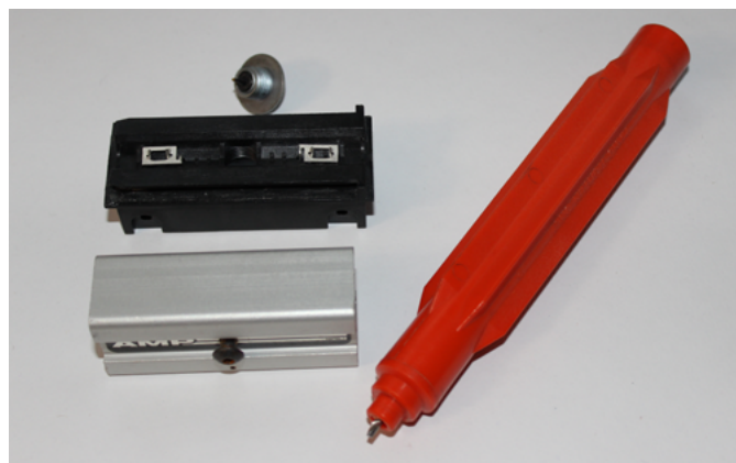
Abb. 2: Vampire Tap mit Mittelkontakt und Bohrwerkzeug
