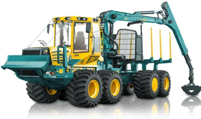
Abbildung 1.1: Kranrückzug HSM 208F12
