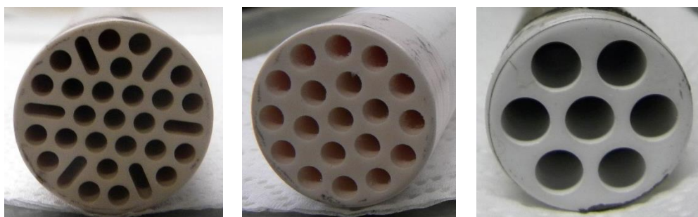
Abb. 3.6: Gegenüberstellung der verwendeten keramischen Rohrmembranen vom Typ 31 KR (l), NKR und SKR (r.)
