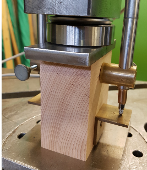
Abbildung 7.4: E-Modul Bestimmung: Versuchsdurchführung
