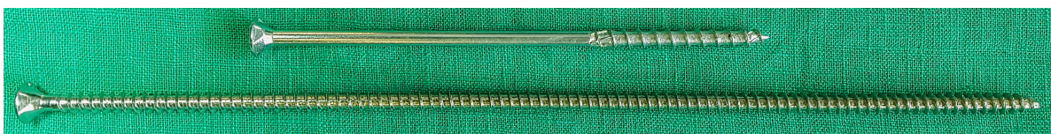
Abbildung 7.6: Schraubentypen: oben Fagus-Schraube-I , unten Vollgewindeschraube
