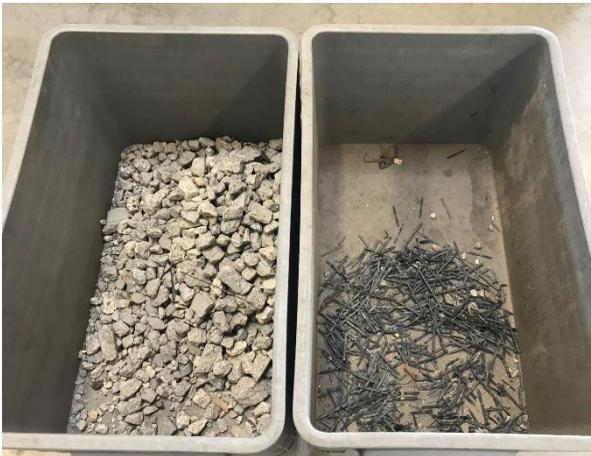
Abbildung 4.1: Separiertes Abbruchmaterial nach der Kamerabasierten Sortierung
