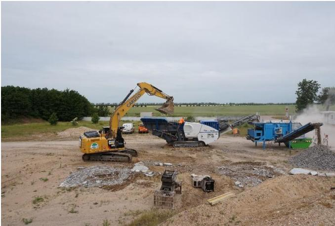
Abbildung 2.1: Backenbrecher und angeschlossener Windsichter
