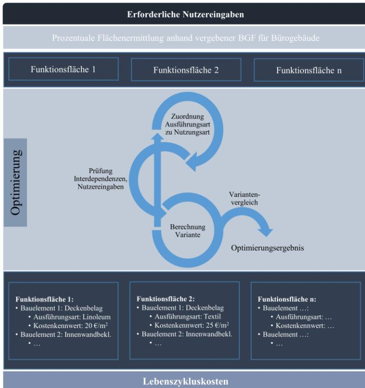
Abbildung 3.1: Optimierungszyklus LZK-SIM [BAU] (eigene Darstellung)
