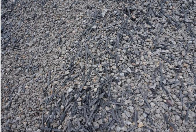
Abbildung 3.1: Heterogenes Abbruchmaterial 0/16 nach dem ersten stationären Aufbereitungsprozess mit Querstromsichtung
