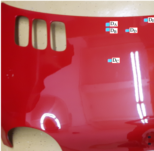
Abbildung 6.19: Defektpositionen auf der Oberfläche
