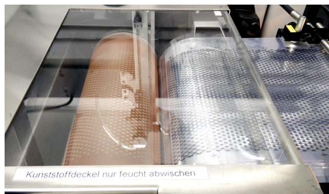
Abb. 29 Schmierendes Druckbild an der Rolle-zu-Rolle Druckmaschine ohne rheologische Anpassung des PEDOT:Tos (links), gutes Druckbild nach additiverter Anpassung des PEDOT:Tos (rechts).
