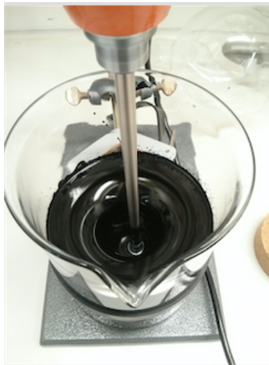
doughnut -Effekt während des dispergierens
