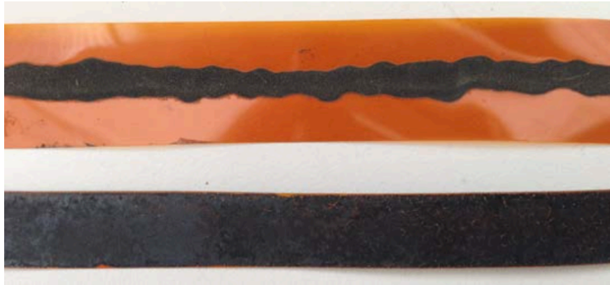
Abb. 10 Per Dispenserdruck aufgetragene PolyMett Struktur auf Kapton Folie.
