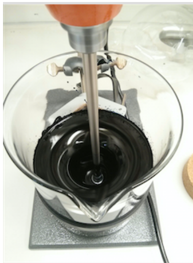
doughnut -Effekt während des dispergierens
