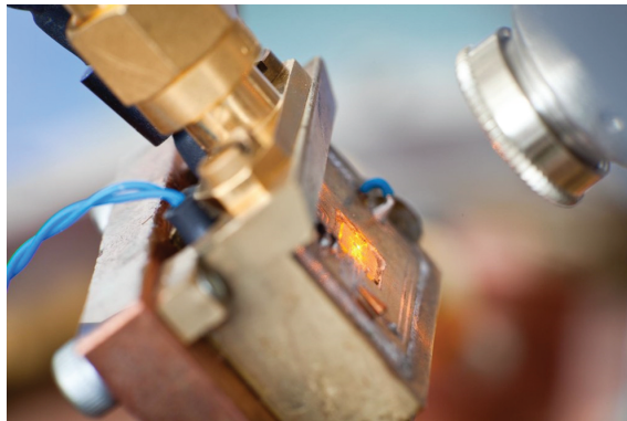
Abbildung 2.5: Blick auf Detektor und Optik bei offenem Kryostaten. Das Bild wurde mit freundlicher Genehmigung durch das Leibniz-Institut für Photonische Technologien e.V. (Sven Döring) zur Verfügung gestellt.
