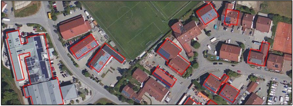
Abb. 81: Automatisierte Erkennung von PV-Bestandsanlagen in Freiburg. Dächer, auf denen bestehende PV-Anlagen durch das neuronale Netz erkannt wurden, sind rot hervorgehoben. Quelle: Mainzer et al. (2017).
