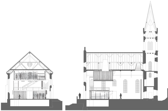
Nutzungserweiterung durch Einbauten in die Kirche in Schönbrunn (Quelle: Diplomarbeit Martin Dittmann am KIT)
