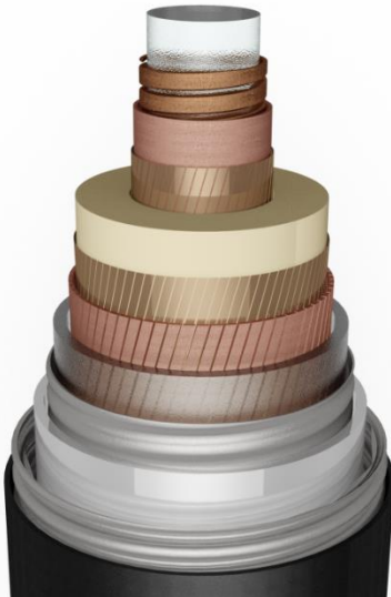
Abbildung 3.17: Konzeptionelles Design eines supra-leitenden Höchstspannungskabels.
