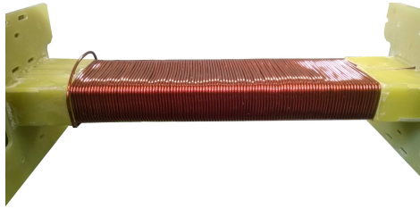
Abbildung A.6: Eingebettete Sekundärwicklung mit 109 Windungen pro Schenkel
