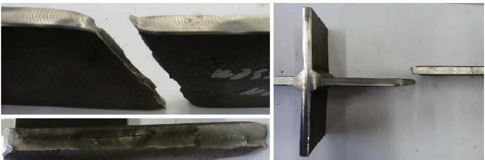
Abbildung 43: Bruchfläche der Probe mit Quersteife 40-8-96Q-40 mit Versagen im Grundmaterial
