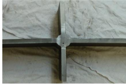
Abbildung 14: Beidseitige Quersteife mit Kehlnaht
