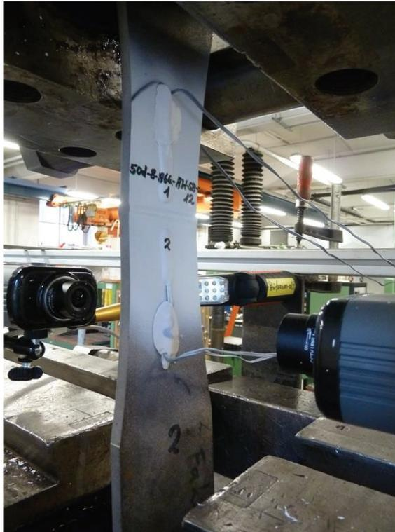
Abbildung 16: Versuchsbegleitende Dehnungsmessungen und Rissfortschrittsaufzeichnungen
