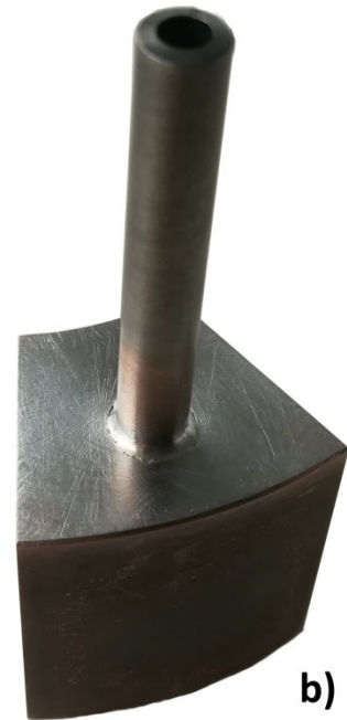
Abbildung 21: Montage im Autoklav a), einer Lötprobe mit kupferbeschichtetem Inconel-718 und Incusil-10 Lot b)
