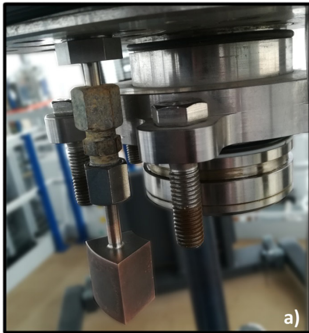
Abbildung 21: Montage im Autoklav a), einer Lötprobe mit kupferbeschichtetem Inconel-718 und Incusil-10 Lot b)
