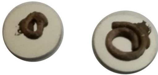
Abbildung 19: Benetzungstest für Incusil-10 auf Inconel 718 im Vakuumofen
