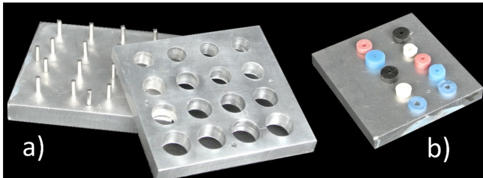
Abbildung 41: Gießform für 2-Komponentensilikon a) und Proben von Innendichtungen unterschiedlicher Materialien b)
