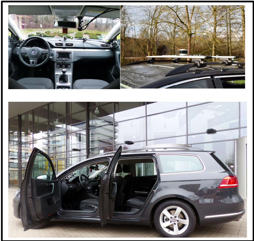
Abbildung 28. Ifab Versuchsfahrzeug. Oben links: Cockpit mit Eye-Tracking-System; Oben rechts Lidarsensor;; Unten Mittig: Gesamtansicht.
