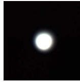
Abbildung 3.8 Farbaufnahme der Impulsantwort des modifizierten Objektivs. Bildweite d_i = 60,3 mm, Brennweite f = 52,4 mm, Blendenzahl k = 1,8 und Gegenstandsweite d_o = d_{o, \text{fok}} - 5 cm.
