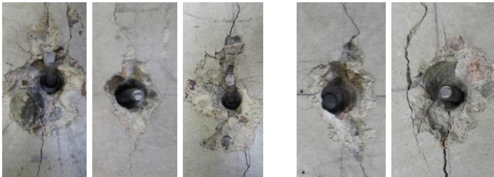
Abbildung 4.53: Bruchbilder der Prototypen; links: MM-EQ 12x100 (zweiteilig); rechts: MM-EQ 12x80 (einteilig)
