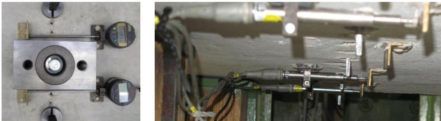
Abbildung 4.9: Messung der Rissbreite bei den Risskeilplatten; links: Oberseite neben dem Prüfling mit zwei Messuhren; rechts: Unterseite mit einem induktiven Wegaufnehmer unterhalb des Bohrlochs
