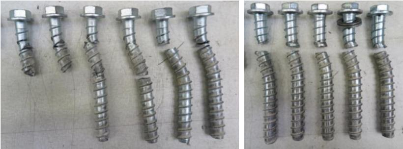
Abbildung 2.48: geprüfte herkömmliche Betonschrauben aus den Versuchen C2.4 nach ETAG001;
