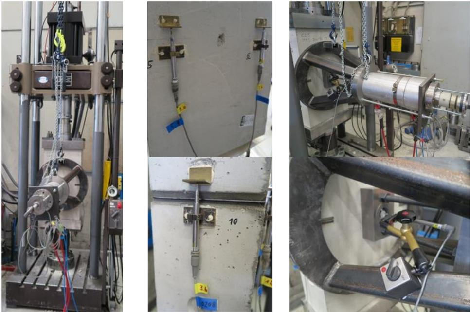
Abbildung 4.19: Details des Versuchsaufbaus mit konstanter Längskraft und zyklischer Rissbreite
