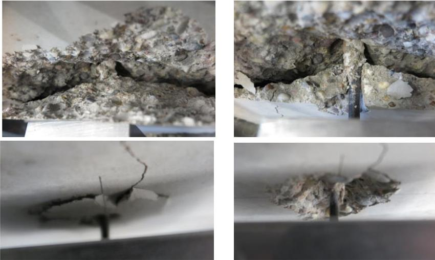
Abbildung 4.72: Versagensbilder Herausziehen der duktilen Schraubanker MM-EQ, oben: MM-EQ 12x160 mit  $d_o = 8,8$  und  $10,7$  mm; unten: MM-EQ 12x80 mit  $d_o = 5,1$  mm
