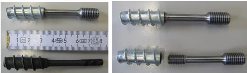
Abbildung 3.2: Prototypen der duktilen Schraubanker MM-EQ  $d_{\text{Schaft}} = 5,1$  mm
