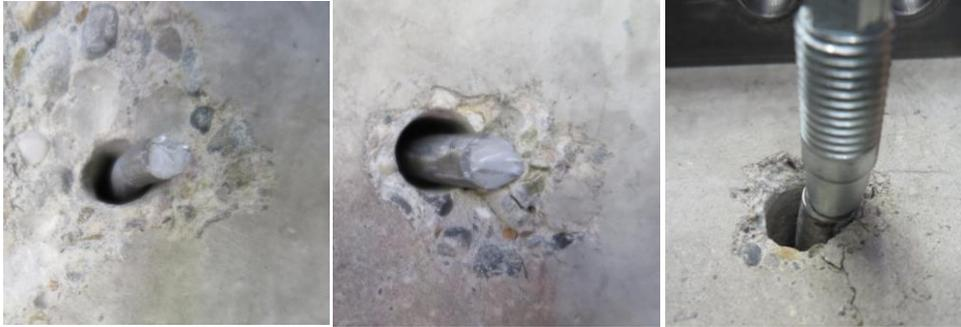
Abbildung 4.23: Versagensbilder der modifizierten Betonschrauben unter monotoner Querlastbeanspruchung; links: d12 – Probe P2; mittig: d16 – Probe P3; rechts: d20 – Probe P1
