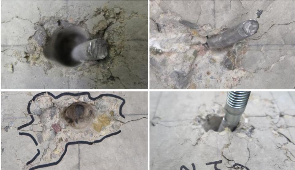
Abbildung 4.30: Versagensbilder der Versuche C2.4 an modifizierten Betonschrauben; oben links: d12 – Probe P6 nach vorzeitigem Versagen; oben rechts: d12 – Probe P2 nach Ermittlung der Resttragfähigkeit; unten links: d16 – Probe P6 nach vorzeitigem Versagen; unten rechts : d20 – Probe P4 nach Ermittlung der Resttragfähigkeit
