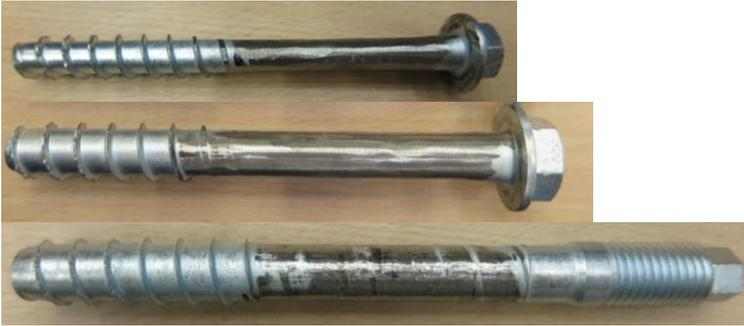
Abbildung 4.20: modifizierte herkömmliche Betonschrauben; von oben nach unten: d12, d14 und d20
