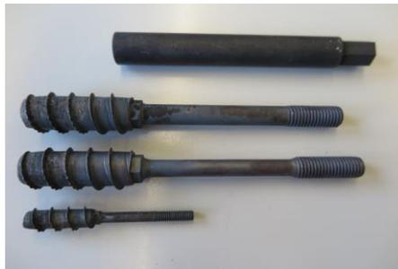
Abbildung 3.3: Prototypen der duktilen Schraubanker MM-EQ (von unten nach oben: mit  $d_{\text{Schaft}} = 5,1$  mm,  $d_{\text{Schaft}} = 8,8$  und  $d_{\text{Schaft}} = 10,7$ ) samt Setzwerkzeug
