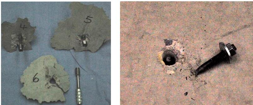
Abbildung 4.59: Bruchbilder quasi-statischer Versuche an Prototypen  $d_{\text{Schaft}} = 5,1 \text{ mm}$
