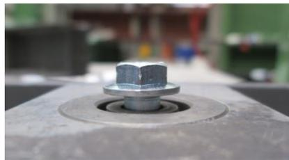
Abbildung 4.38: Herkömmliche Betonschraube, montiert mit Spalt zwischen Mutter und Anbauteil
