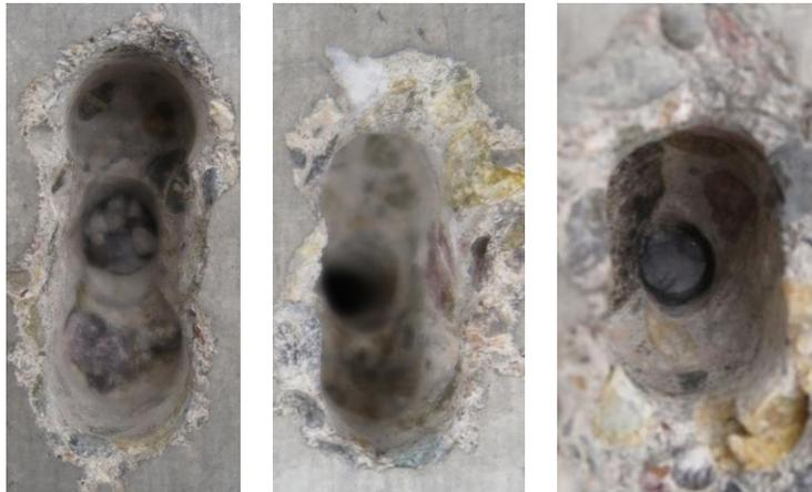
Abbildung 4.33: Bohrlöcher der Prüfungen C2.4 in Langlöchern; links: d12; mittig: d16; rechts: d20
