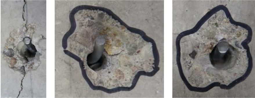
Abbildung 4.50: Bruchbilder des Prototyps  $d_{\text{Schaft}} = 5,1 \text{ mm}$
