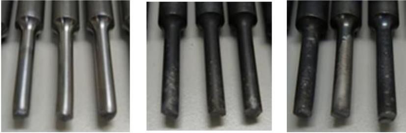
Abbildung 4.4: Bruchbilder der Prüflinge nach den Hin- und Herbiegeversuchen; links: unbehandelt; mittig: gehärtet und flammangelassen; rechts: gehärtet
