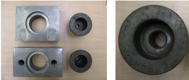
Abbildung 4.7: Stahlbacke und Einsteckbuchse als Anbauteil
