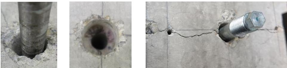
Abbildung 4.21: Montage und Versuchsvorbereitung mit den modifizierten Betonschrauben
