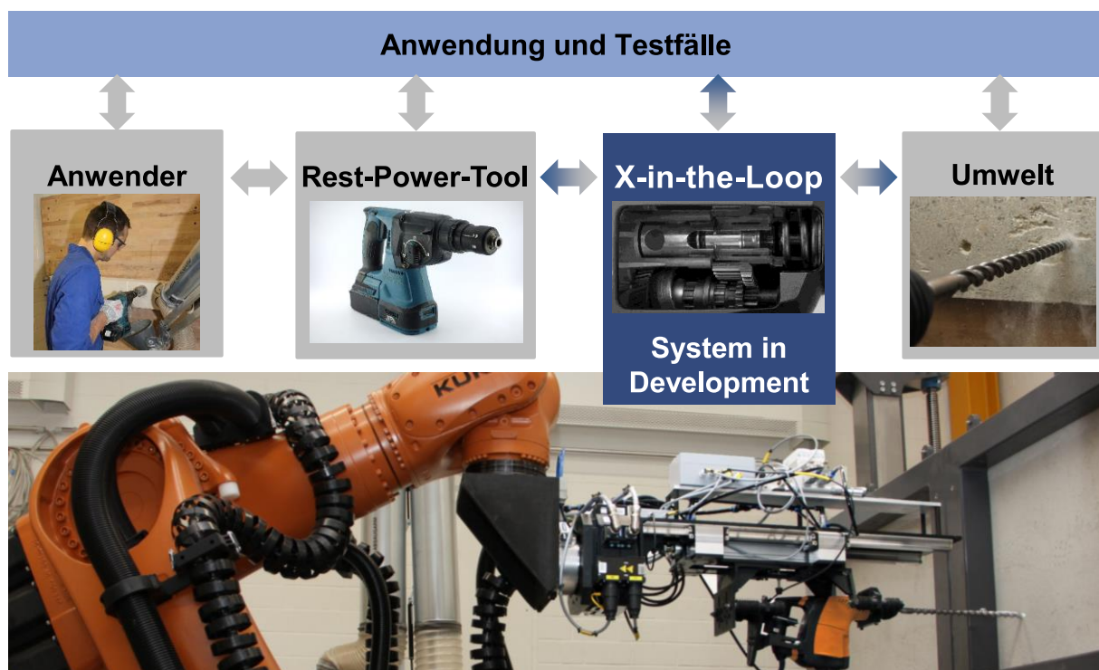
Abbildung 2.9: IPEK-X-in-the-Loop-Ansatz für handgehaltene Power-Tools nach MATTHIESEN ET AL. 119
