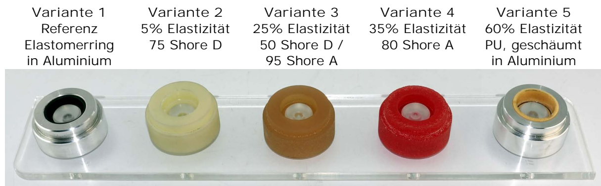
Abbildung 7.2: Varianten des Lagersitzeinsatzes für die Untersuchung des Einflusses der Lagersitzeigenschaften auf die Radialschwingung der Motorwelle eines Winkelschleifers.
