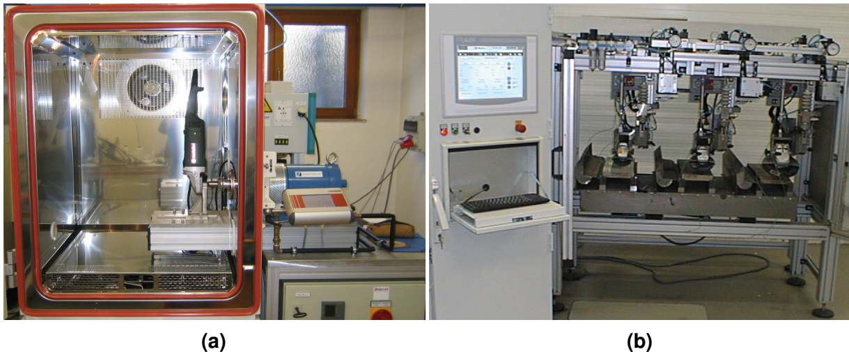
Abbildung 2.14: Prüfstände für Lebensdaueruntersuchungen. In (a) Klima-Prüfstand zur Umweltsimulation, in (b) Winkelschleifer-Schrupp-Prüfstand. 136
