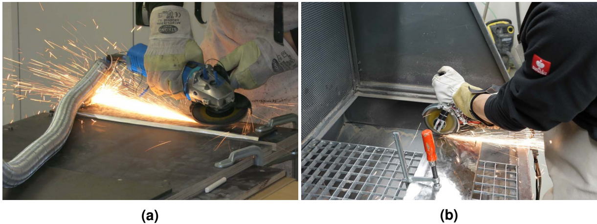
Abbildung 5.11: Fotos der manuellen Versuche mit den Sensorgeräten im Power-Tool Testcenter des Instituts. In (a) ist der Testfall Schleifen von Stahl mit Sensorgerät ID179, in (b) der Testfall Trennen von Stahl mit Sensorgerät ID190 gezeigt. 223
