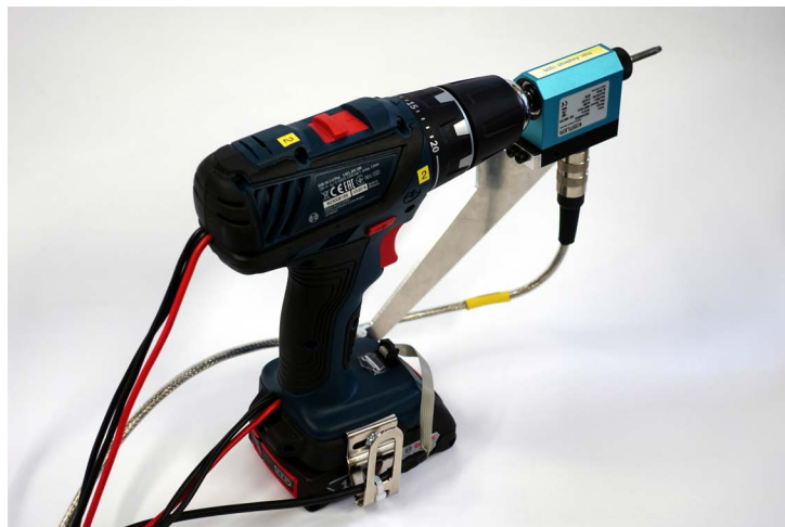
Abbildung 5.26: Fotografische Darstellung des Sensorschraubers zur Messung der mechanischen Größen an der Werkzeugaufnahme und den elektrischen Größen.
