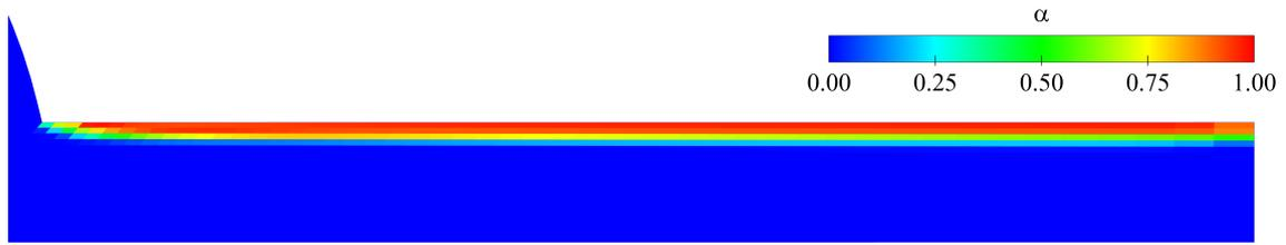
Abbildung 4.6: 2D Injektor: Simulation der kavitierenden Strömung unter Verwendung des Modells 2F-SFM p in AVL Fire™. Dargestellt ist der Volumenanteil der dispersen Phase  $\alpha$  zum Zeitpunkt  $t = 2e^{-4}$ s. Die grafische Auftragung erfolgte mit Ensiight 10.2.3(a). [S3]
