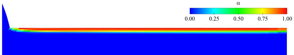
Abbildung 4.3: 2D Injektor: Simulation der kavitierenden Strömung unter Verwendung des Modells 2F-SFM N in AVL Fire™. Dargestellt ist der Volumenanteil der dispersen Phase  $\alpha$  zum Zeitpunkt  $t = 2e^{-4}$  s. Die grafische Auftragung erfolgte mit Ensight 10.2.3(a). [S2]
