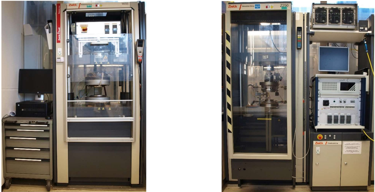
Abbildung 14: Zum Heißprägen verwendete Wärmeumformmaschinen WUM 01 (links) und WUM 02 (rechts).
