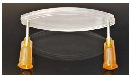
Abbildung 8: Erster durch Mikrofräsen hergestellter und durch Ultraschall verschweißter Prototyp eines mikrofluidischen Bioreaktors mit durch Presspassung befestigte Dosiernadeln für den fluidischen Anschluss.
