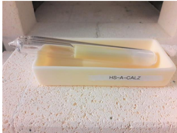
Abbildung A18: Quarzglasröhrchen mit Probe im \text{Al}_2\text{O}_3 -Tiegel, evakuiert und abgeschmolzen.
