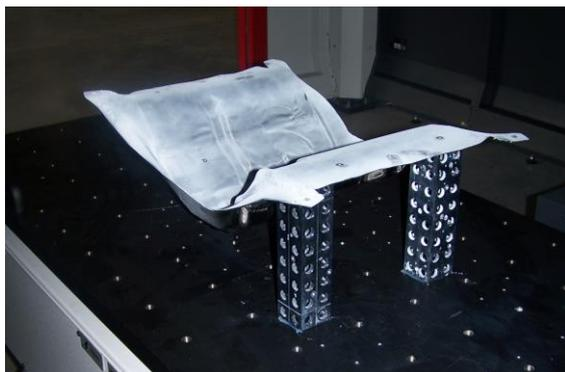
Abbildung 63: Bild eines mit Kreidespray behandelten Bauteils zur einseitigen 3D-Vermessung in einer automatisierten Messzelle
