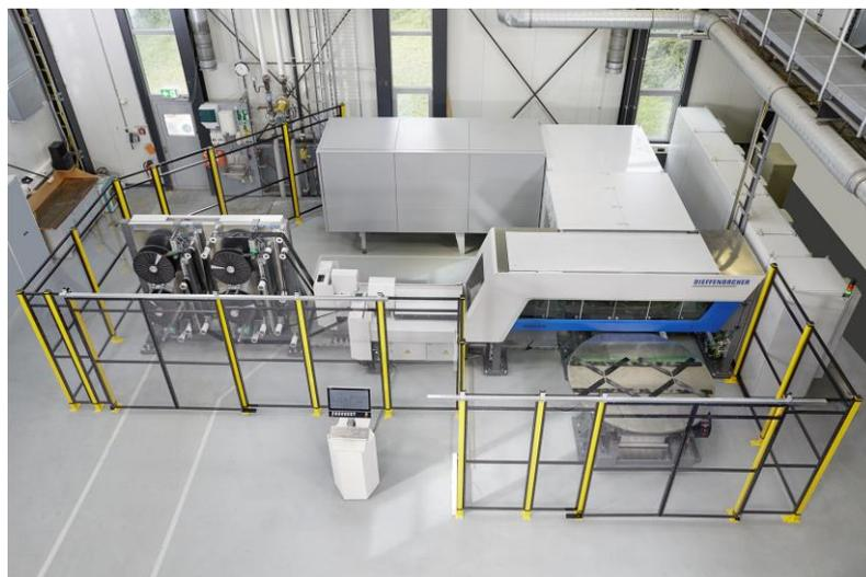
Abbildung 3: Dieffenbacher Fiberforge-Tapelege-Anlage im Technikum des Fraunhofer ICT
