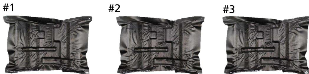
Abbildung 61: Fotos umgeformter Gelegelaminat bei 5mm Restweg im dreifachen Wiederholungsversuch, Lagenaufbau  $[0/-45/90/+45]_s$
