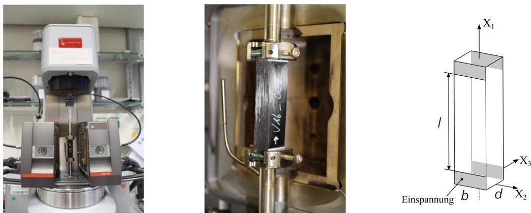
Abbildung 26: Links: Rheometer mit Prüfkörperfixierung und Temperierkammer
