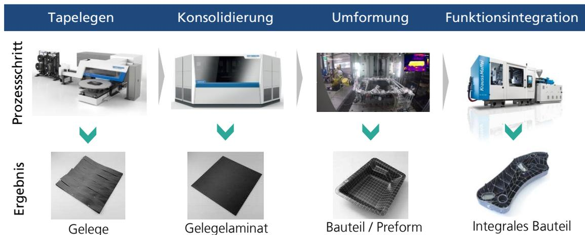
Abbildung 4: Darstellung der sequentiellen Tape-Prozesskette
