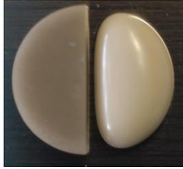
**Abbildung 2.5:** Gesintertes (links) und kristallisiertes (rechts) Bariumsilikat SCHOTT G018-311.
