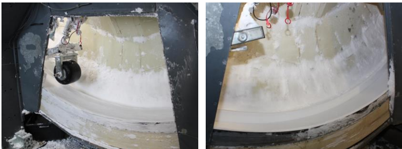
Abbildung 3.6: Frisch eingewalzte Schneefahrbahn mit Walze (links); Fahrbahn kurz vor Ende der nutzbaren Schneeschicht (rechts) [Was15]
