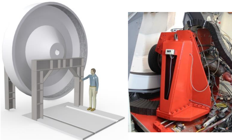
Abbildung 3.3: Schematische Darstellung des IPS (links); Radführung (rechts)
