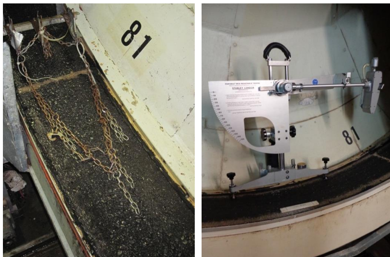
Abbildung 3.5: Wiederaufbereitung der Asphaltfahrbahn (links) und Messung der Mikrorauigkeit bei Nassmessungen (rechts) [Was14]
