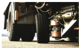
Abbildung 2.9: oben: Reifen-Messanhänger von TASS International [TAS15a], [TAS15b]; unten: Reifen-Messfahrzeug Universeller Reibungsmesser (URM) des FKFS [FKF15a], [FKF15b]
