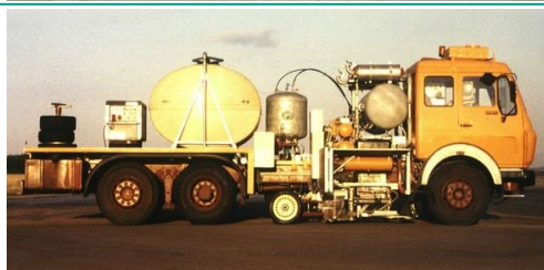
Abbildung 2.9: oben: Reifen-Messanhänger von TASS International [TAS15a], [TAS15b]; unten: Reifen-Messfahrzeug Universeller Reibungsmesser (URM) des FKFS [FKF15a], [FKF15b]
