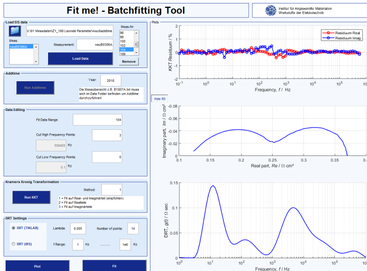
Abbildung A.1: Startfenster der FITME-Software. Hier werden (i) die Messdaten eingelesen, (ii) der Zeitstempel der Messdaten bestimmt, (iii) die Kramers-Kronig-Residuen berechnet und (iv) die DRT berechnet. [Zell# Z1_188]
