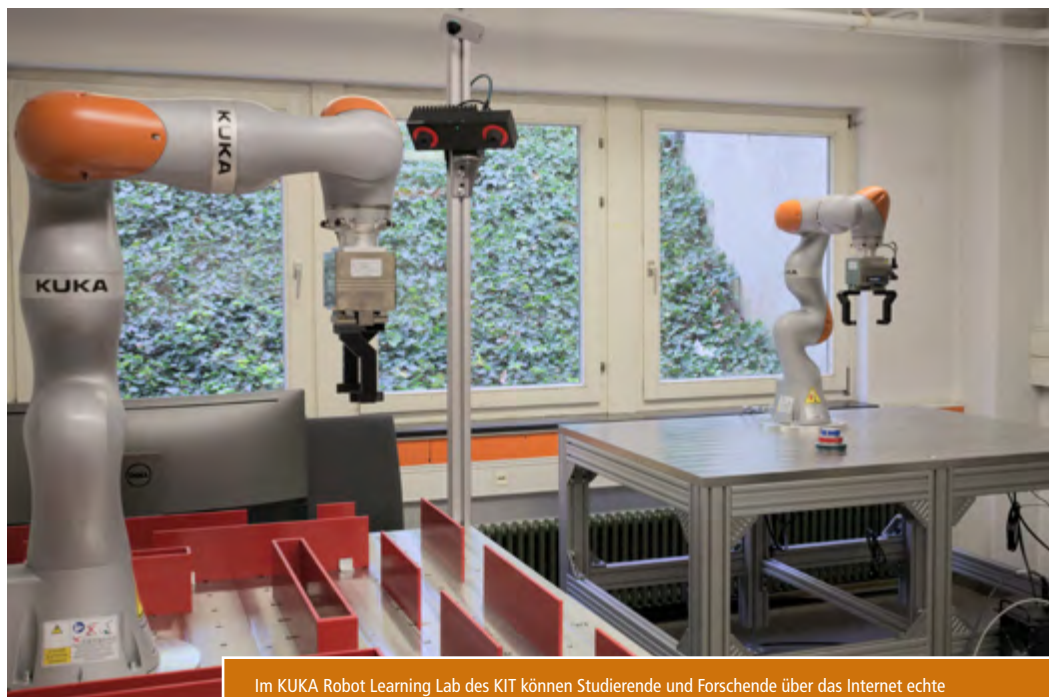
Im KUKA Robot Learning Lab des KIT können Studierende und Forschende über das Internet echte Industrieroboter steuern und so ihre Programme testen.
