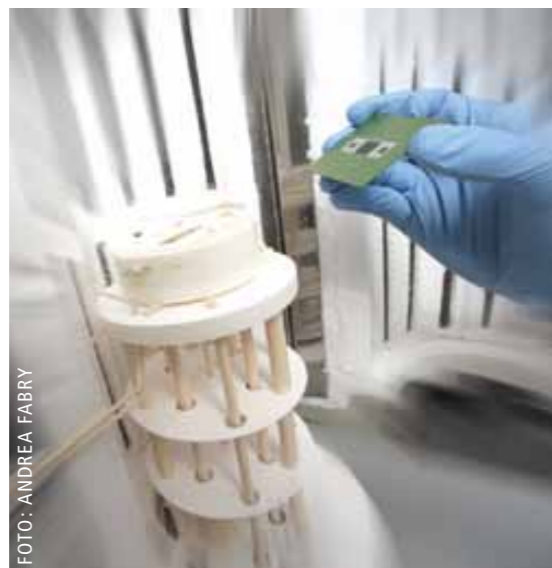
Einbau einer SOFC-Einzelzelle in den Teststand
