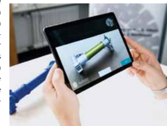
Mit dem Tablet in eine virtuelle Umgebung eintauchen: Auf dem Bildschirm werden Varianten einer Seilwinde eingeblendet. Das Original liegt auf dem Tisch davor
