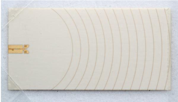
Abbildung 4.14: Für die Messung mit Klebeband auf Rohacell-31-HF-Schaumstoff fixierte Antenne.
