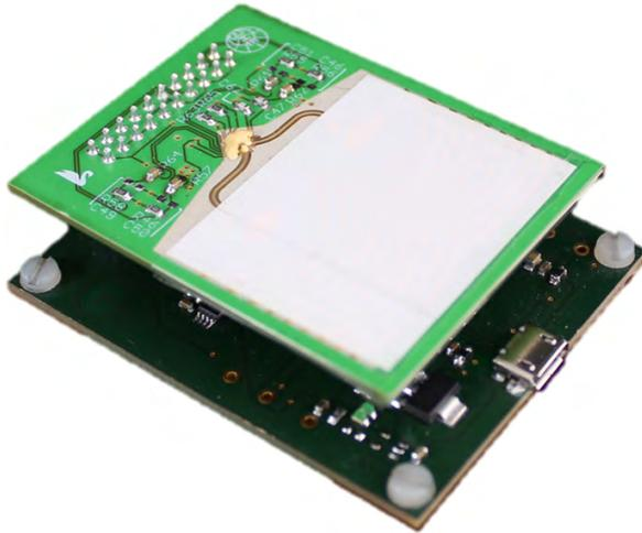
Abbildung 6.8: Funktionsfähig aufgebauter Radarprototyp aus Radarplatine (oben) und Basisbandplatine (unten).
