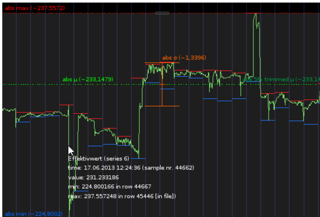
Abbildung 5.22: Vergrößerter Ausschnitt (ca. 20 s) des Effektivwerts in den EDR-Merkmalen am selben Tag, welcher sowohl das Tagesminimum als auch das Tagesmaximum enthält und auf einen weiteren Spannungseinbruch hindeutet.
