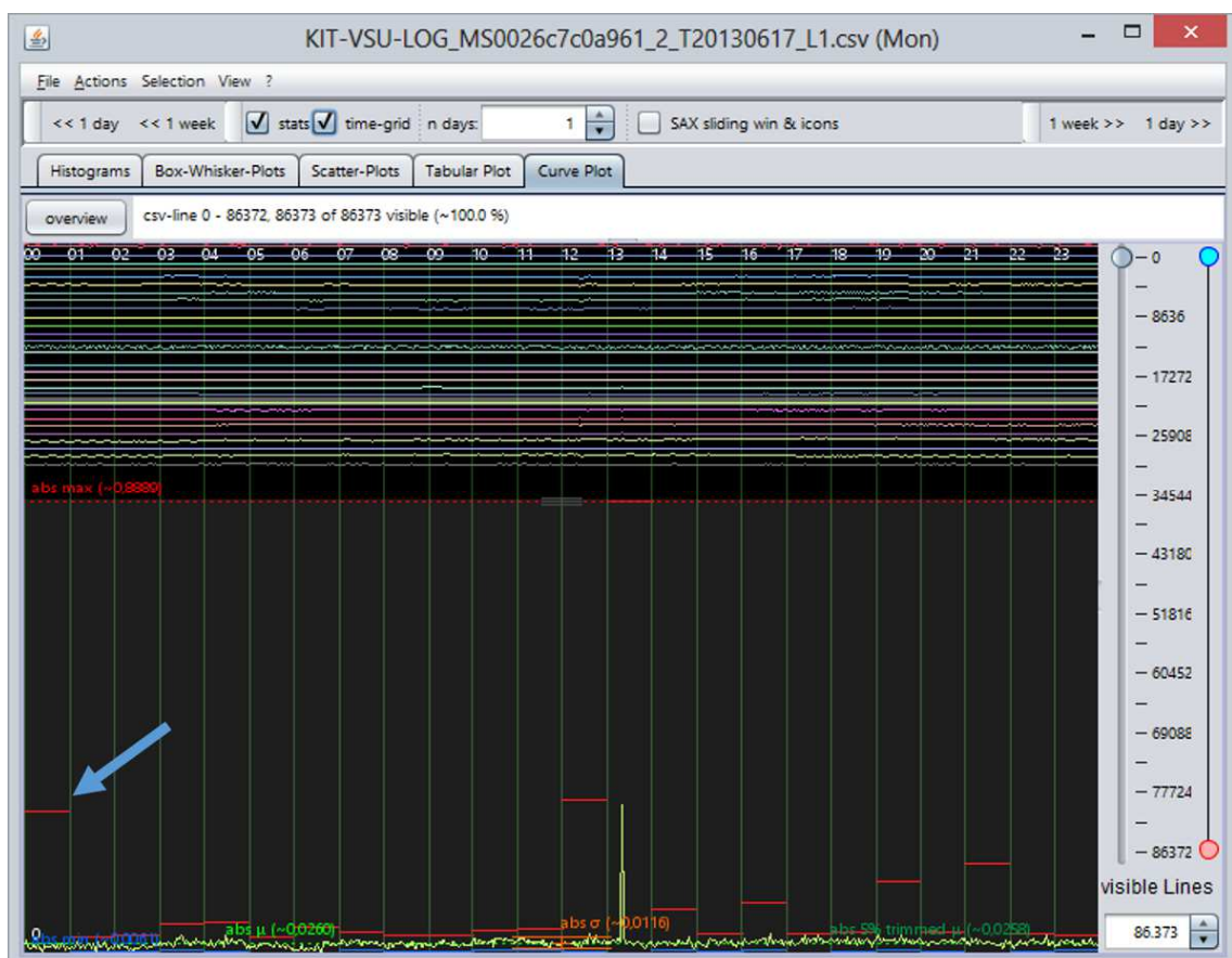
Abbildung 4.14: Beispiel einer Unterabtastung bei der Kurvendarstellung in ViAT mit verborgenden lokalen Maxima, die durch Einblendung von Zeitbereichsstatistiken sichtbar werden (z.B. bei blauem Pfeil).
