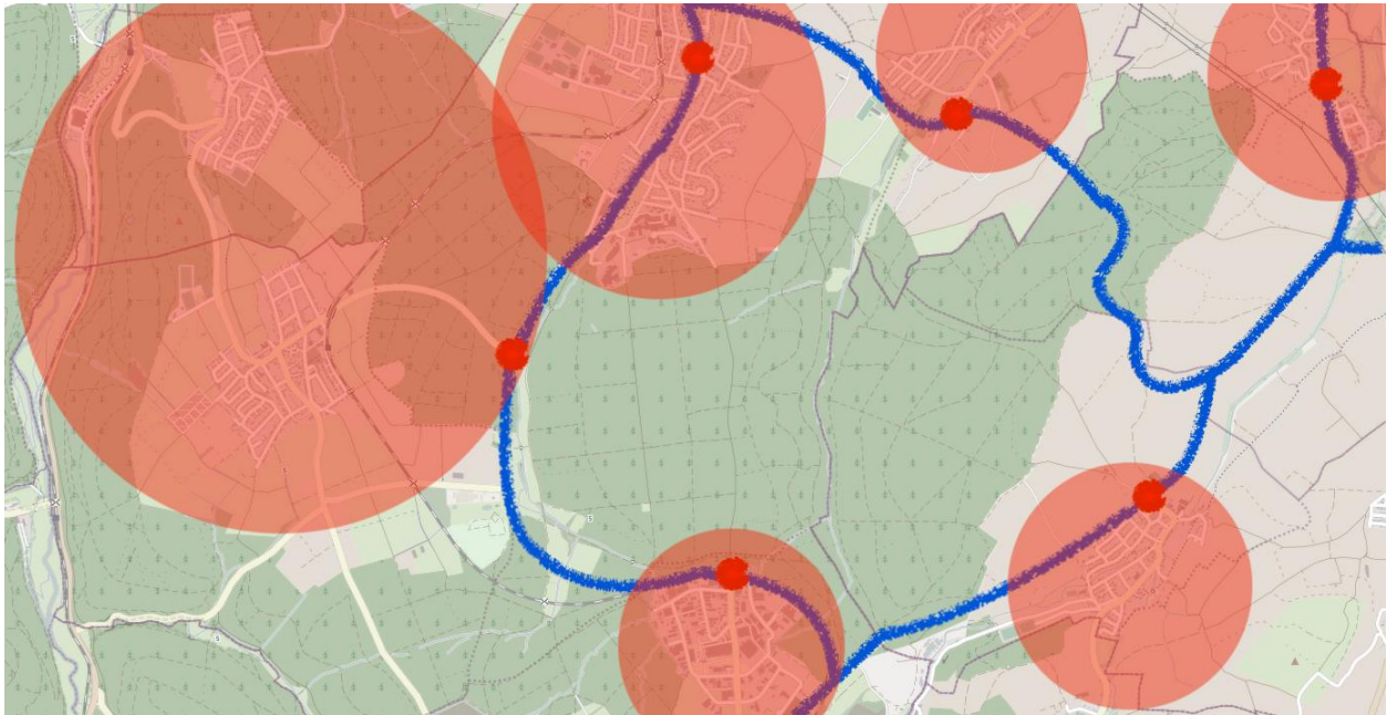
Abbildung 6: Verkehrsnetz des ÖPNV. Die blauen Linien stellen ein stationäres Liniennetz dar; die roten Bereiche werden von den autonomen Kleinbussen aus Fallstudie 3 abgedeckt und sind über die eingezeichneten roten Punkte mit dem stationären Liniennetz verbunden (Straßenkarte aus [42])
