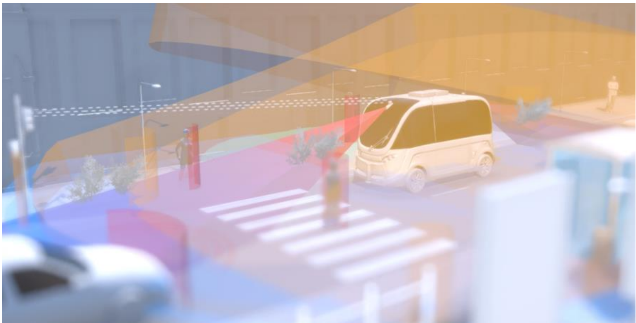
Abbildung 2: Shuttle-Bus des Herstellers Navya inklusive Sichtfelder der Fahrzeugsensoren [29]
