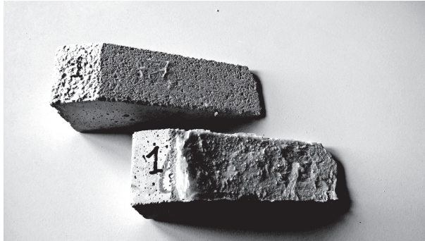
Abbildung 4-5: Schubprismenversuche: Gemischt kohäsiv-adhäsives Versagen aller Novipro-Putz Proben
