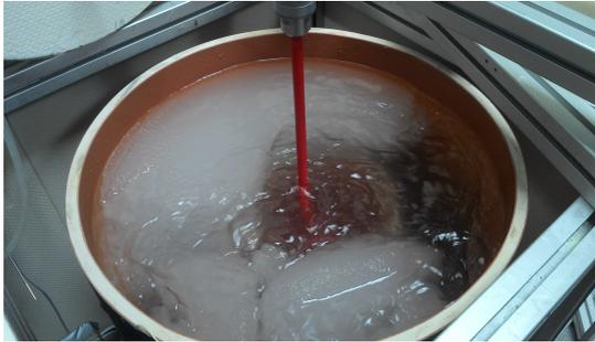
**Abbildung 4.1.** Beispiel für typisches Absetzen der Eispartikel durch unzureichende Durchmischung
