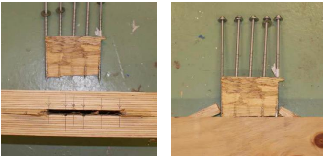
Bild 2-4 Reihenscherversagen (Versagensmechanismus (d) in Bild 2-2) bei Schraubenauszugsversuchen in LVL von Carradine et al. 2009 [16]
