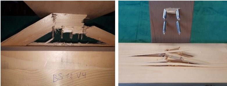
Bild 4-6 kombiniertes Auszieh-Blockscherversagen im Prüfkörper BS 1.2 V4 (links) und kombiniertes Auszieh- und Reihenscherversagen im Prüfkörper BS 2.1 V3 (rechts)
