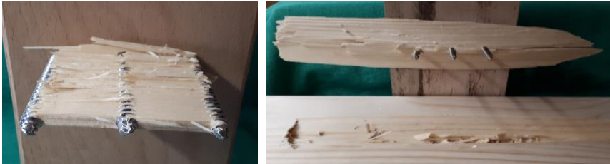
Bild 4-2 Reihenscherversagen im Prüfkörper RS 2.1 V4 (links) und kombiniertes Auszieh-Blockscherversagen im Prüfkörper RS 3.1 V3 (rechts)
