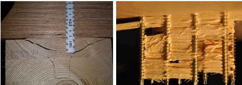
Bild 4-7 Blockscherversagen im Prüfkörper BS 3.2 V4 (links) und Reihenscherversagen im Prüfkörper BS 1.2 V1 (rechts)
