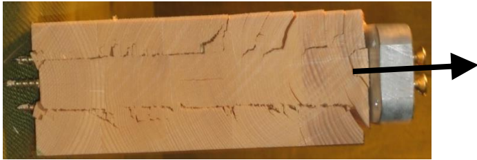
Bild 2-3 Blockscherversagen (Versagensmechanismus (c) in Bild 2-2) bei Endauflagern mit aufgeschraubten Blechen und Schrauben über die ganze Höhe des Holzbauteils
