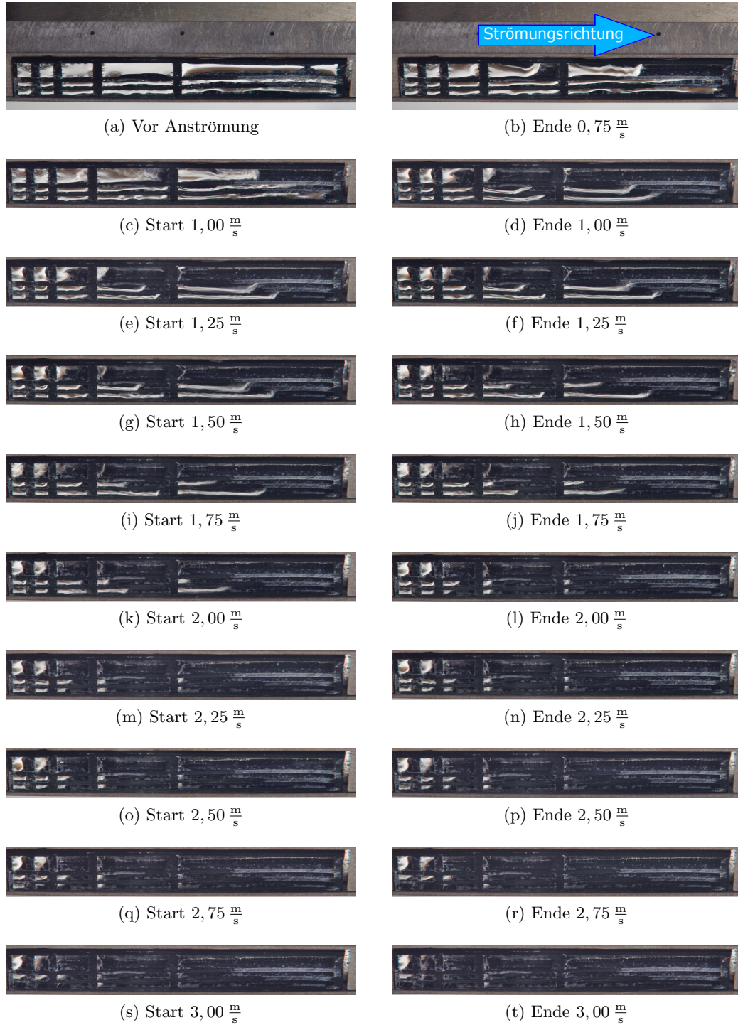
Abbildung 4.9: Überströmungsverlauf bei verschiedenen Kompartimentgrößen. Auf einer Probe wurde der Einfluss der Kompartimentgröße untersucht. Die Kompartimente haben die Längen 1,5 mm, 3,5 mm, 8 mm und 17,5 mm, die Breiten sind jeweils 3,5 mm sowie 1,25 mm. Je kleiner die Kompartimentlänge, desto stabiler ist die Lufthaltung bei Überströmung. Die kleinsten Kompartimente zeigen eine stabile Lufthaltung bis zu der Geschwindigkeit u = 2,5 \frac{m}{s} (p). Wie bei den Kompartimenten mit Säulen erfolgt der Luftverlust gegenläufig zur Strömungsrichtung beginnend an der abschließenden Kompartimentwand.
