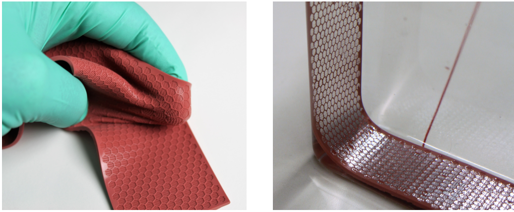
Abbildung 4.20: Flexibilität von SHH-Elementen. Durch die Elastizität des Silikons als Probenmaterial können Proben reversibel gedehnt werden. Da die gesamte Probe monolithisch über ein Gußverfahren hergestellt wurde, werden die Kompartimente sowie die Haken nicht zerstört bei einer Dehnung. Die Lufthaltung ist auch bei der gekrümmten Probe vorhanden.
