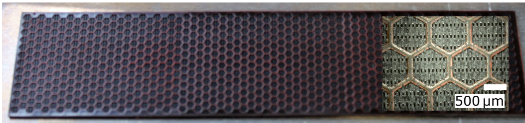
(a) schwarzgefärbtes Epoxidharz mit Kompartimentwänden aus Photopolymer
