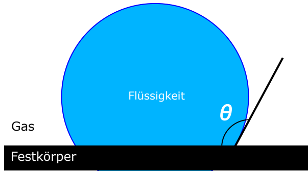
Abbildung 2.1: Kontaktwinkel \Theta auf einer ebenen, homogenen Oberfläche. Durch die verschiedenen Grenzflächenenergien der drei Phasen zueinander bildet sich bei Benetzung einer Oberfläche eine materialabhängige Tropfenform aus. Die Benetzung wird mit dem Kontaktwinkel \Theta angegeben.
