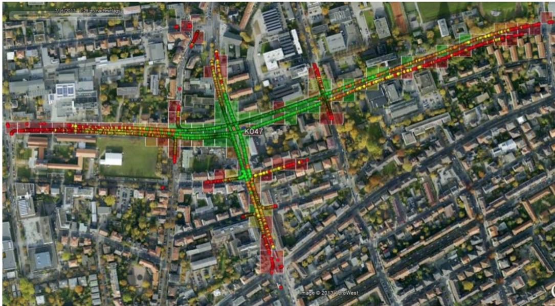
Abbildung 21: Messergebnis von RSU-Reichweiten an einer Forschungskreuzung [49]
