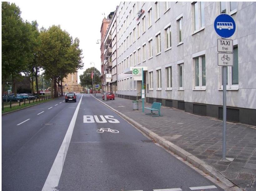
Abbildung 12: Abmarkierter Busfahrstreifen [151]
