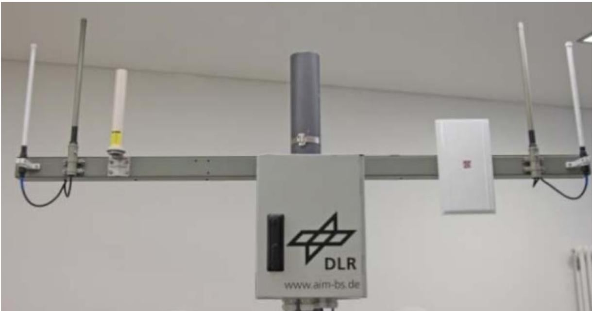
Abbildung 13: RSU mit Antennenträger des DLR [33]
