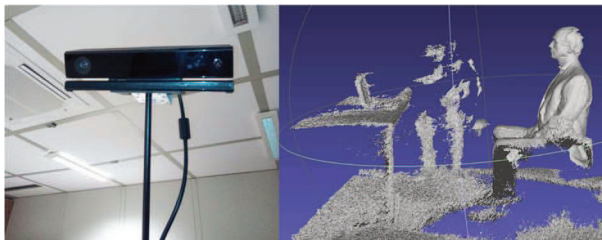
Abbildung 19: 3D-Scanning; Kamera Microsoft Kinect (links), Mesh aus Scanning (rechts)
