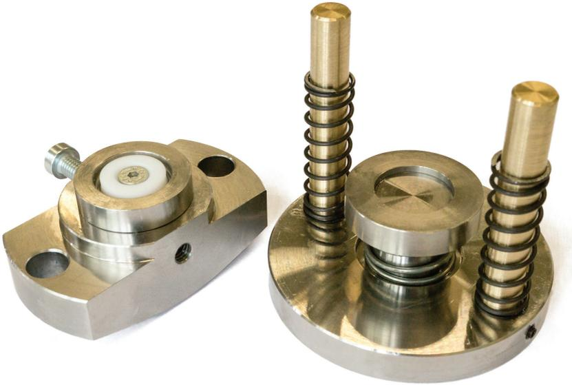
**Abbildung B.4:** Knopfzellen-Bördelpresse demontiert.
