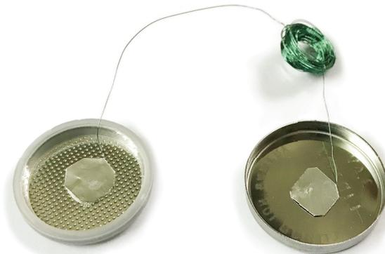
**Abbildung 4.17:** Kalibrierknopfzelle mit Heizspirale.
