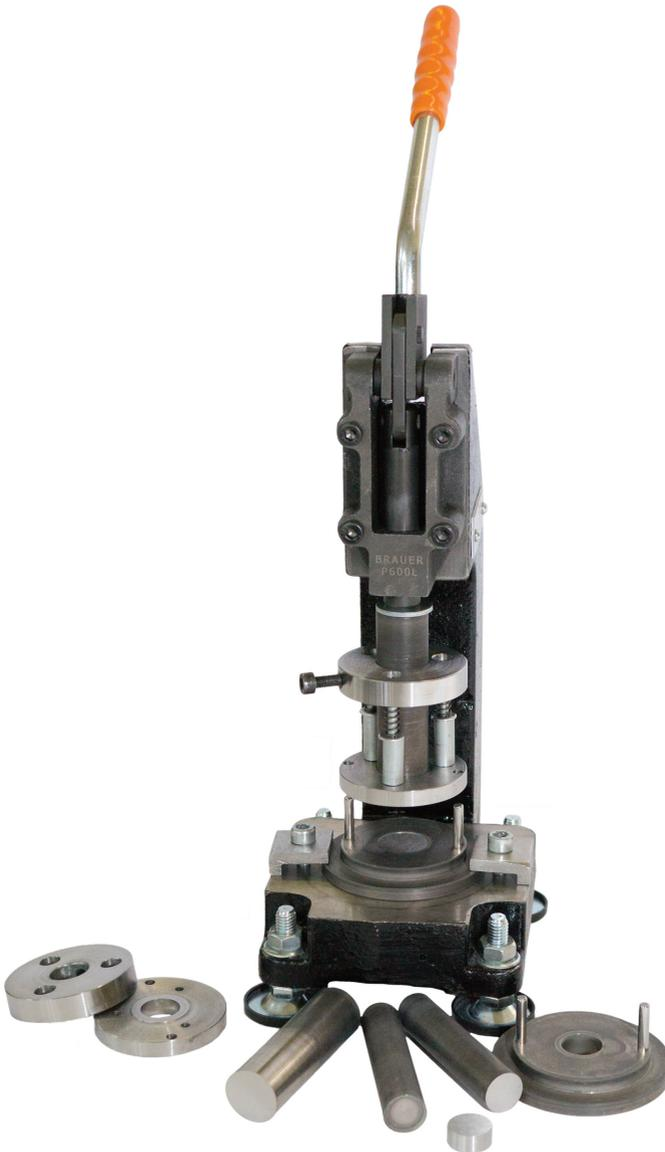
**Abbildung B.2:** Kniehebelpresse mit Elektroden-Stanzwerkzeugen. Stanzwerkzeuge: gehärtet durch Plasmanitrieren und geschliffen.
