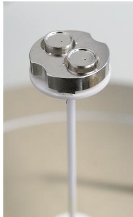
**Abbildung 4.11:** Pt/Rh- $c_p$ -Probenträger mit Proben- und Referenztiegel.
