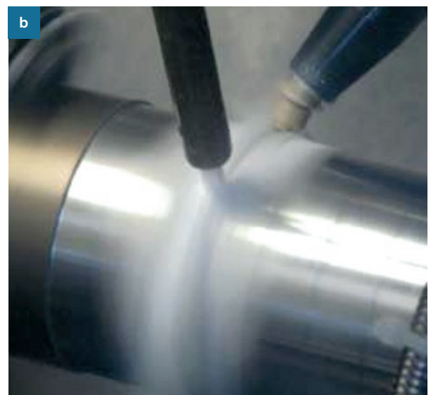
Abb. 15: (a) Schematische Darstellung des Festwalzen (Kloos & Adelman 1988), (b) Festwalzen unter kryogener Kühlung (Meyer, Brinksmeier & Hoffmann 2011).
