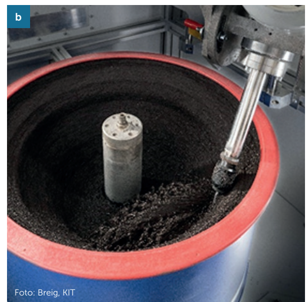
Abb. 11: (a) Simulative und (b) experimentelle Durchführung des Stream Finishing Prozesses.
