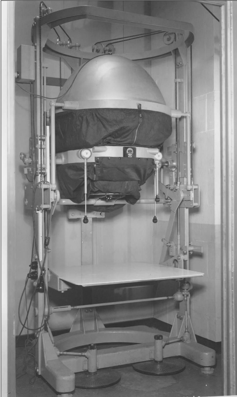
**Abbildung 94: Selbstfokussierendes Entzerrungsgerät SEG I**
