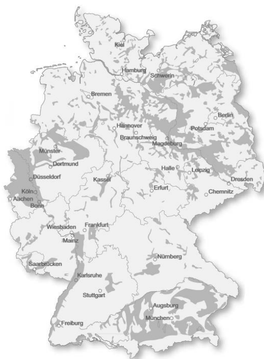
Abb. 1: Verteilung von Bausand und Kiesvorkommen in Deutschland (verändert nach [12,13])
