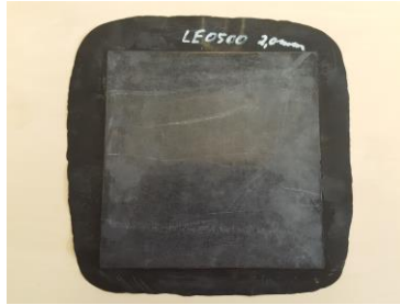
Abb. 49: Hergestellte Pressplatte mit dem Compound LE 0500
