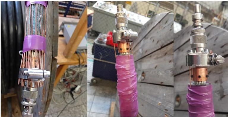
Abb. 127: Messadapter mit 36 (links), 4 (Mitte) und einer (rechts) angeschlossenen Schirmlitze des ca. 136 m langen Mittelspannungskabels
