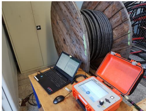
Abb. 173: Teilansicht des Messaufbaus und des Messgerätes Teleflex SX
