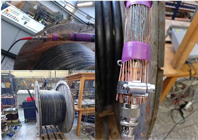
Abb. 125: Angeschlossener Messadapter an ein ca. 136 m langes aufgewickeltes Mittelspannungskabel
