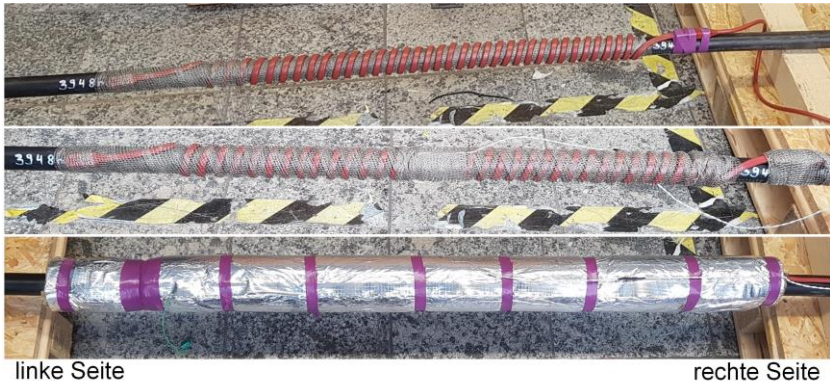
Abb. 155: Montierte Heizwendel mit Geflechtbändern und Isolierung
