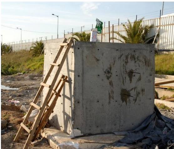
Abb. 14: Probelwürfel für quasiadiabatische Temperaturentwicklung [KREBS+KIEFER]
