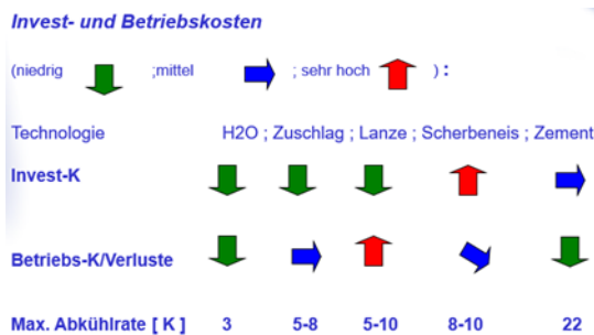
Abb. 7: Vergleich der einzelnen Verfahren zur Frischbetonkühlung
