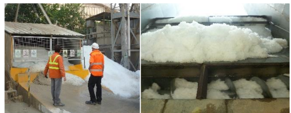
Abb. 3: Dosierung von Eisflakes als „Zugabewasser“
