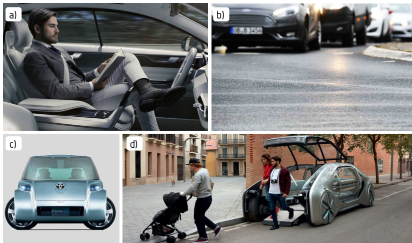
Abbildung 2.1: Autonomes Fahren. a) Arbeiten und Entspannen erfordern geringe Aufbaubewegungen. b) Städtischen Straßenkreuzung mit mehrere Zentimeter tiefen Spurrillen. c) Hohe Manövrierbarkeit erleichtert automatisiertes Fahren und Parken. d) Neue Raumkonzepte erfordern flach bauende Fahrgestelle. Bildquellen [g-Afb19].
