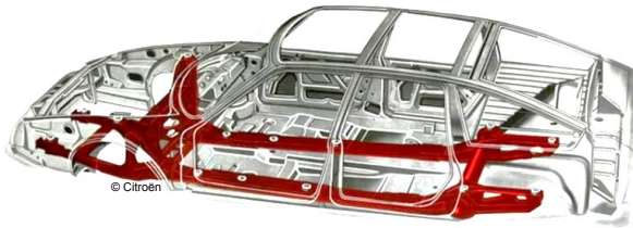
Abbildung 3.14: Teiltragender Fahrwerkrahmen des Citroën CX (1974) zur Isolation des gummigelagerten Aufbaus gegen Anregungen von Antrieb und Rädern [g-Cmw19].
