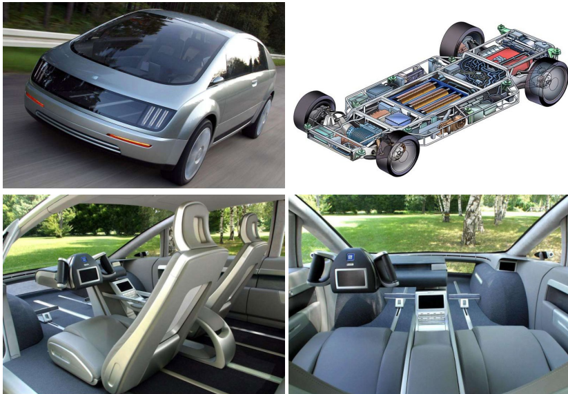
Abbildung 3.12: General Motors Brennstoffzellen-Konzeptfahrzeug Hy-Wire (2002) mit flachbauendem Fahrgestell und neuem Raumkonzept [i-Gch02].
