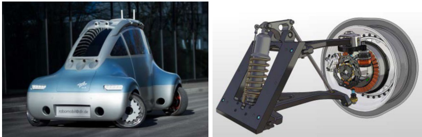
Abbildung 3.6: Das ROboMObil des DLR. Antriebsmotor und Lenkaktor sind im Rad untergebracht, [k-Bre11]. Die Federung wird über ein Pushrod betätigt, um Raum für große Radlenkwinkel zu schaffen.
