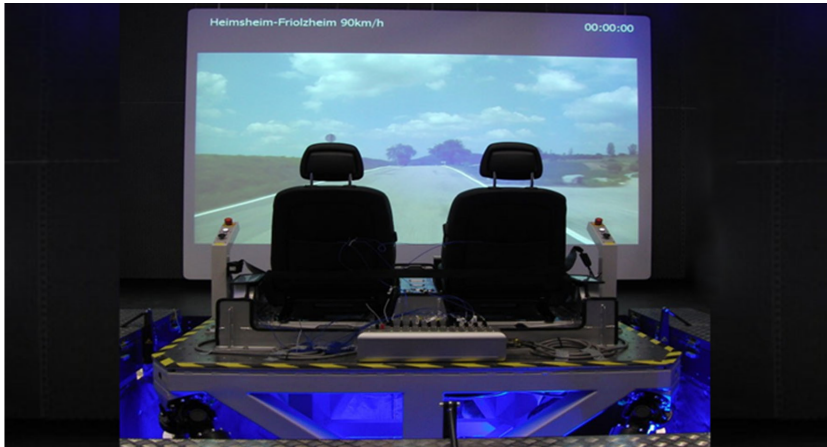
Abbildung C.3: Ride-Simulator zur vergleichenden Subjektivbeurteilung des Schwingungskomforts aus simulierten Sitzkonsolenbeschleunigungen [i-Drs19].
