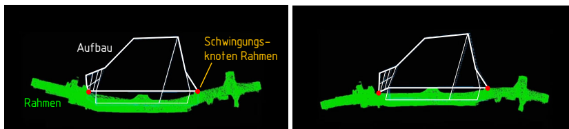
Abbildung 3.15: BMW Forschungsfahrzeugs Z22 (1990) mit Lagerung der Aufbaukabine in den Schwingungsknoten des Fahrwerkrahmens [i-Bmw90].
