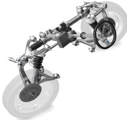
Abbildung 3.4: Vorderachse des ZF Intelligent Rolling Chassis der Zahnradfabrik Friedrichshafen mit 75 Grad Vorderradlenkwinkel [i-Zfi18].
