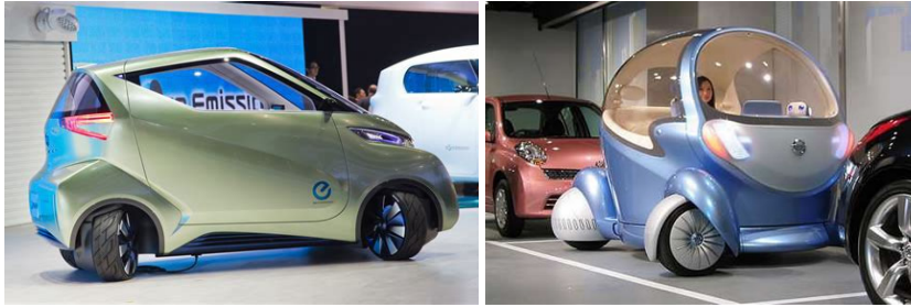
Abbildung 3.5: Nissan Konzeptfahrzeuge. Pivo 3 (2011) Wendekreis 4 m, Radlenkwinkel kleiner 90 Grad, [i-Npt11]. Pivo 2 (2007) mit Querparkfunktion [i-Npt07].
