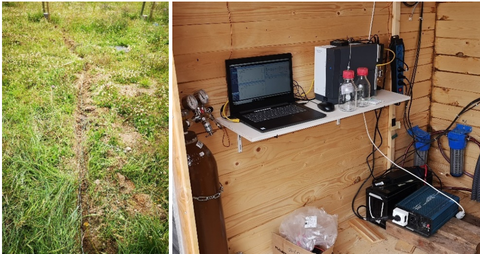
Abbildung 16: Verlegung der Peek-Gasschläuche zu den einzelnen Stützen und Schächten (links). Aufbau und Anschluss der Schläuche an dem Mikro GC in der Hütte (rechts) (Fotos: Victoria Griebmeier).
