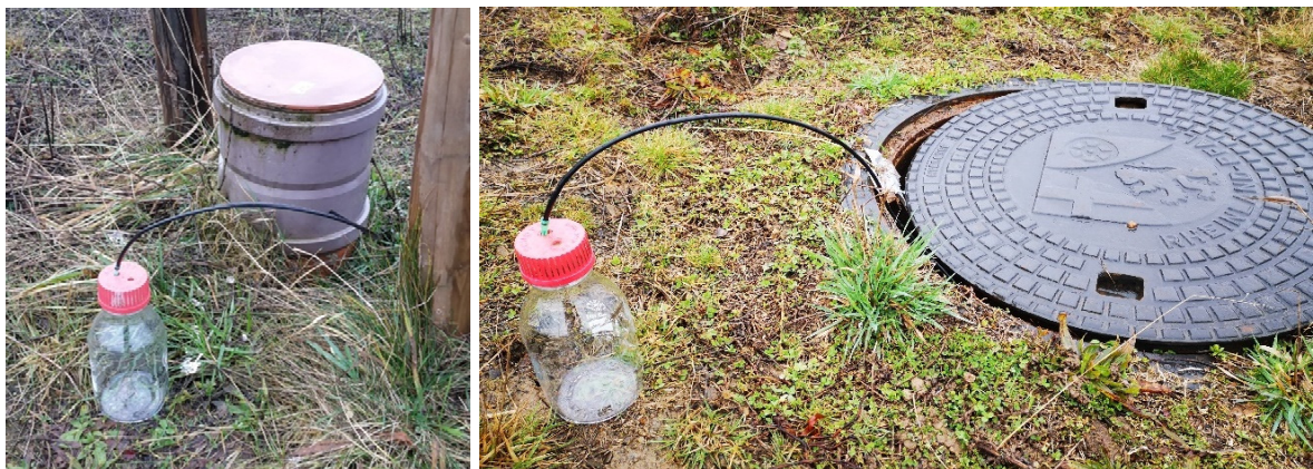
Abbildung 15: Gasprobenentnahme an den Stutzen (links) der Anlage D7 und an den Schächten (rechts) mit vakuumisierten Flaschen (Fotos: Victoria Griebmeier).
