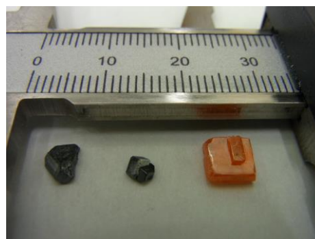
Abbildung 3.3: Makroskopische \text{CH}_3\text{NH}_3\text{PbI}_3 (links und mittig) und \text{CH}_3\text{NH}_3\text{PbBr}_3 (rechts) Perowskitkristalle hergestellt aus einer Perowskit-Präkursorenlösung.
