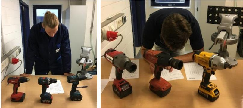
Abbildung 22: Versuchsaufbau der Vorbenutzungsphase zur initialen Bewertung der Griffgeometrie von Power-Tools<sup>234</sup>
