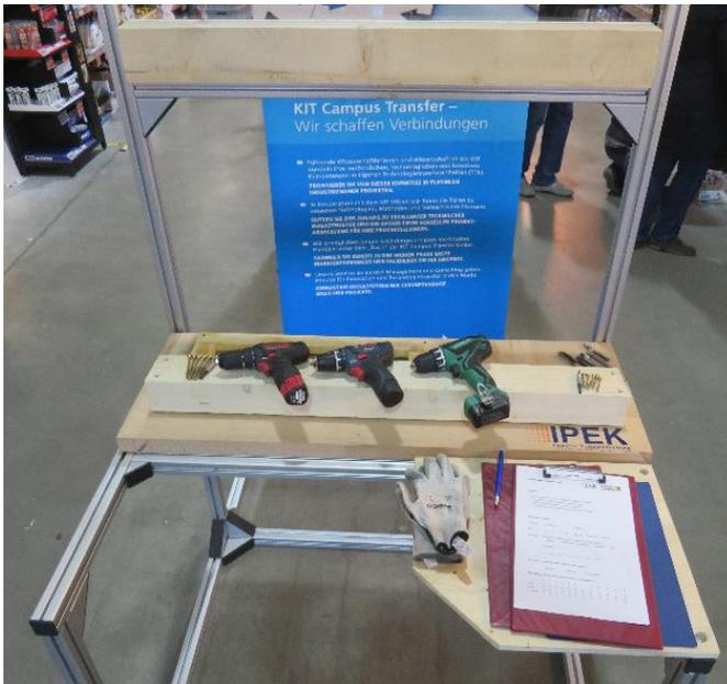
Abbildung 33: Experimentaler Versuchsaufbau zur Beurteilung der Anwendungsqualität von original gelabelten Akkuschraubern<sup>267</sup>
