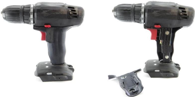
Abbildung 37: Aufbau des modularen Akkuschaubers mit vollständig montierter (links) und offener Griffschale (rechts)<sup>280</sup>
