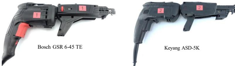
Abbildung 25: geschwärzte, magazinierte Trockenbauschrauber<sup>239</sup>
