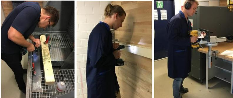
Abbildung 23: Durchführung von Testanwendungen mit Akkuschaubern (links und mittig) und Schlagschaubern (rechts) im Power-Tool Testcenter des IPEK
